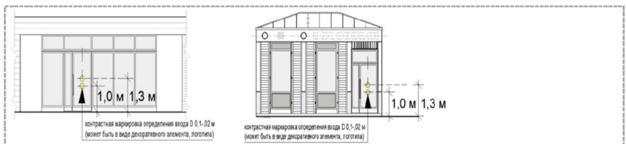
Рис. «Внешний вид контрастной маркировки входа»
